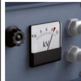
Die Prüfung des Werkzeugs auf Durchschlagsfestigkeit bei 10.000 Volt gibt dem Anwender die beruhigende Gewissheit, dass sein Schraubendreher auf seine wichtigste Eigenschaft, die Isolation, geprüft worden ist. Wera VDE-Schraubendreher werden Stück für Stück dieser Prüfung unterzogen. Sicheres
